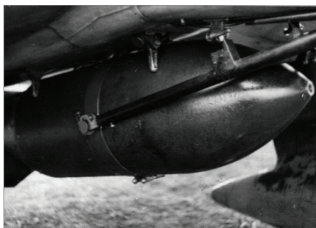
Bomba de 500 kilogramos. Una bomba de 500 kilogramos situada bajo el fuselaje de un Stuka del modelo B. Foto: colección de los autores.
