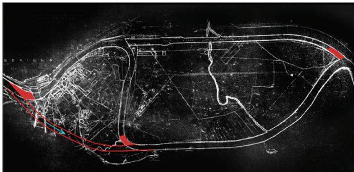
*Imagen 20: Plano en el que podemos observar las tres ejecuciones básicas del Plan Brackenbury: construcción de la esclusa y cerramiento de la dársena en los Gordales y Chapina. Año 1957 (Colección privada Loïc Menanteau).*
